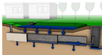
Schema des Mulden-Rigolen-Systems mit gedrosselter Ableitung (Quelle: Sieker)
