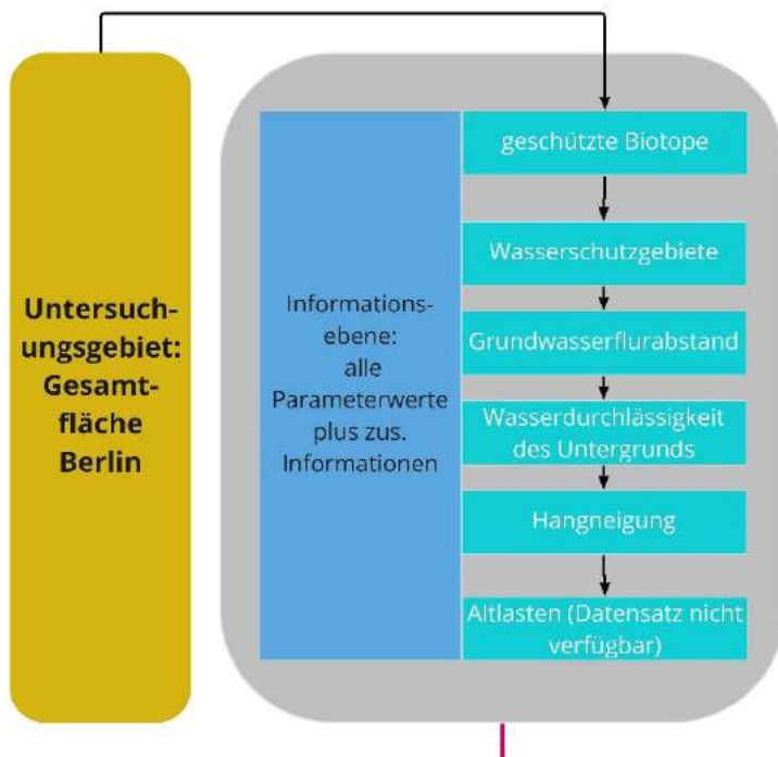
Abbildung 19 Methodik zur Ermittlung des Versickerungspotenzials
