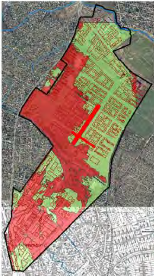
Abbildung 13: Auswertung erlaubter Versickerung für Mulden-Rigolen-Systeme nach Berücksichtigung der Erfordernisse des neuen Leitfadens (IPS 2022).
