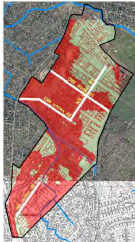
Abbildung 14: Auswertung erlaubter Versickerung für Muldenversickerung nach Berücksichtigung der Erfordernisse des neuen Leitfadens (IPS 2022).
