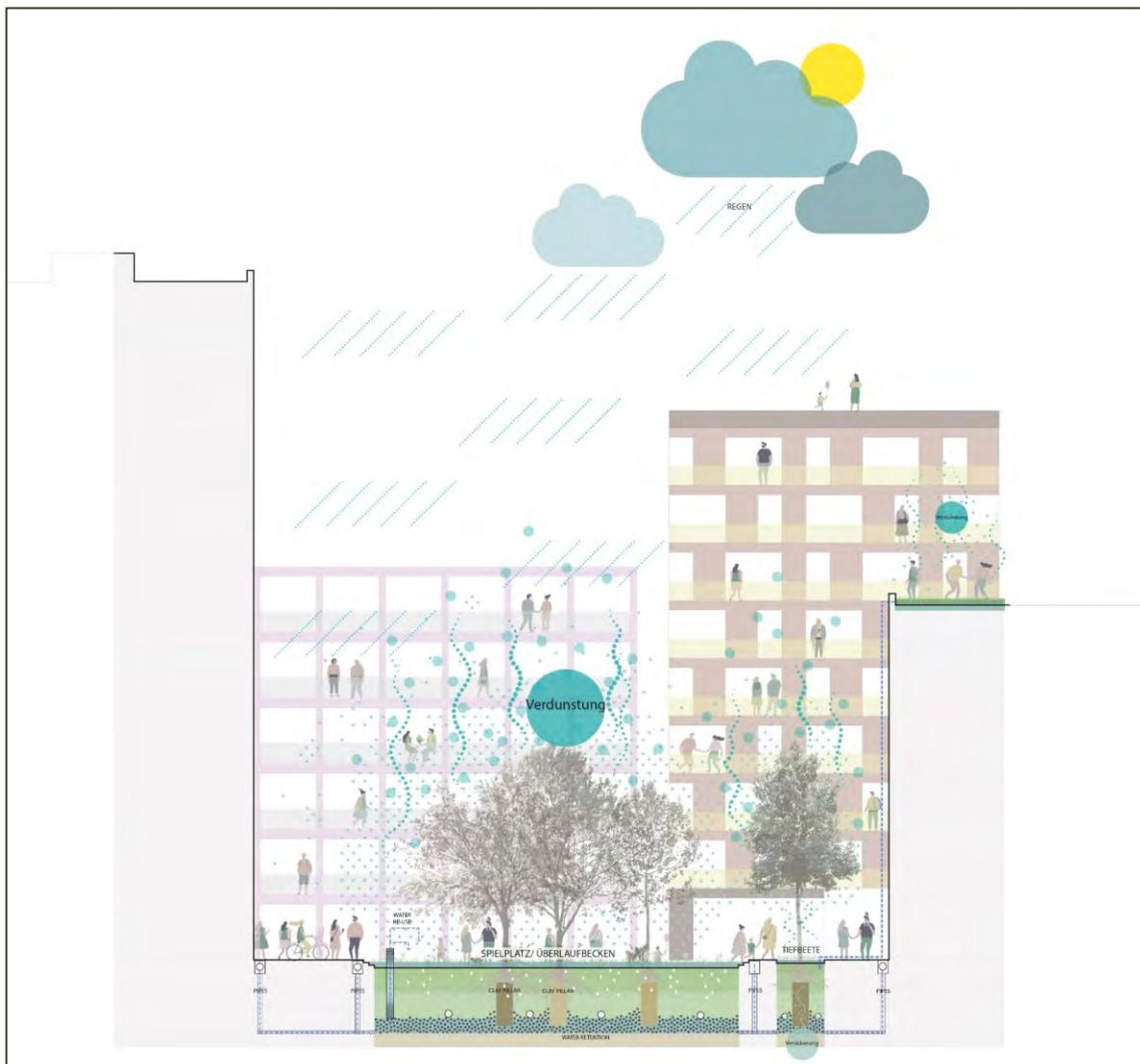
Abbildung 24: Querschnitt durch den Innenhof, Entwässerungskonzept Haus der Statistik
