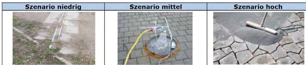
Abbildung 14: Betriebsszenarien - wasserdurchlässige Fläche
